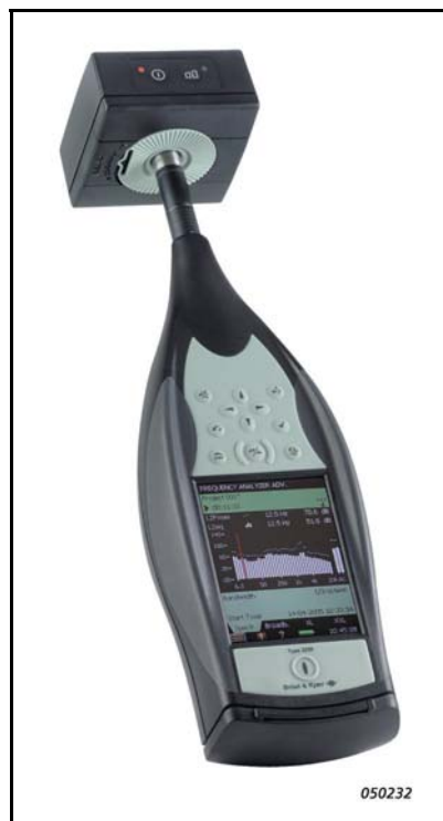
Рис. 2. Калибратор 4231, установленный на портативный анализатор модели 2250. Центр тяжести калибратора расположен очень близко к микрофону, что обеспечивает надежность его крепления
