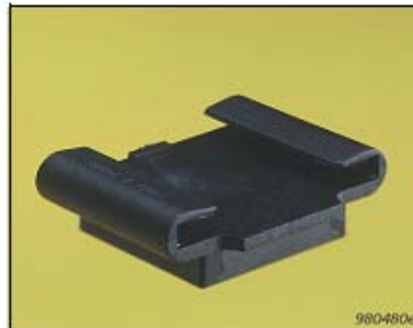
Рисунок 3. Спецификация установочного зажима с толстым основанием UA 1474: Основание можно подпиливать, чтобы оно соответствовало установочной поверхности (см. правый рисунок) Верхняя граничная частота ( \pm 10\% ): - установка со смазкой: 2 кГц - сухая установка: 1.2 кГц Масса: 3.9 г
