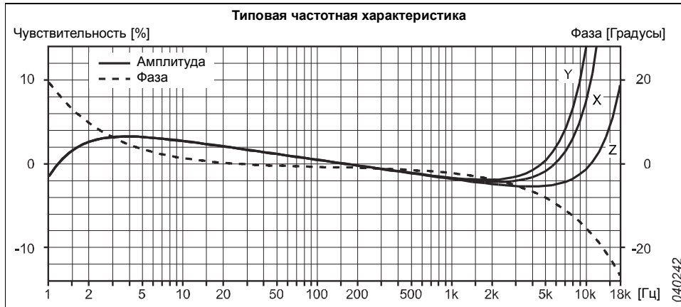
Рисунок 1. Типовая частотная характеристика акселерометра типа 4504A
