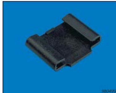
Рисунок 2. Спецификация установочного зажима UA 1408: Верхняя граничная частота ( \pm 10\% ): - установка со смазкой: 2 кГц - сухая установка: 1.2 кГц Масса: 2.1 г
