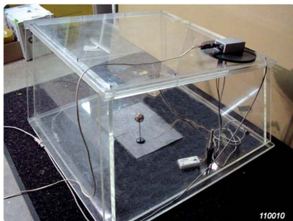
Рис. 32 Измерение масштабной модели в камере с отражениями при помощи миниатюрного ненаправленного источника звука
