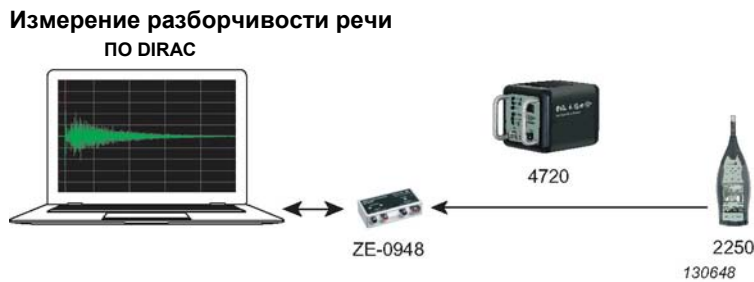
Рис. 6 Измерительная система: возбуждающий сигнал, поступающий от источника Echo Speech Source модели 4720
