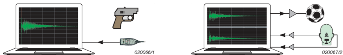
Рис. 19 Слева: измерение времени реверберации и отношения энергий; справа: измерение интер-ауральной функции взаимной корреляции (IACC)
