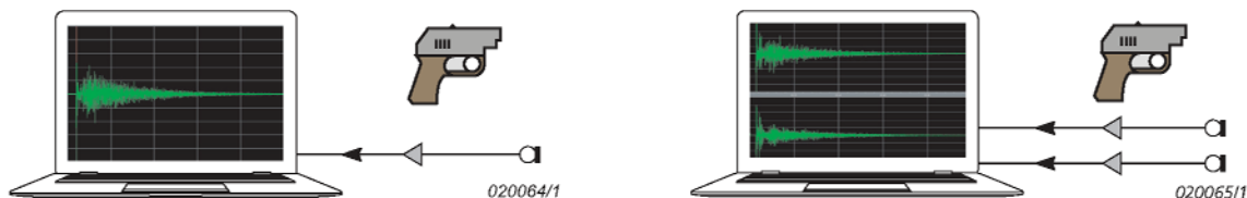
Рис. 17 Метод внешнего импульса: возбуждением является импульсный сигнал, полученный, например, от стартового пистолета или бумажного пакета
