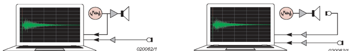
Рис. 16 Метод внешнего шума: возбуждение представляет собой широкополосный сигнал, такой как шум или музыка
