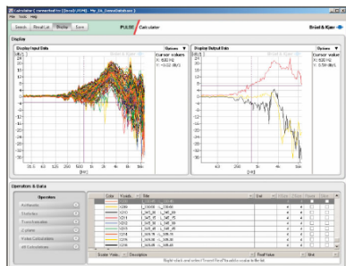
Рис. 6: Программа управления обработкой данных PULSE является мощным средством для сопоставления результатов различных измерений. Данные, полученные с помощью продуктов PULSE, Анализатора звуковых частот типа 2012 и Анализатора звуковых частот на базе компьютера, легко сопоставляются на одном дисплее. Также поддерживается возможность составления отчетов, проведение простых расчетов и даже статистического анализа.
