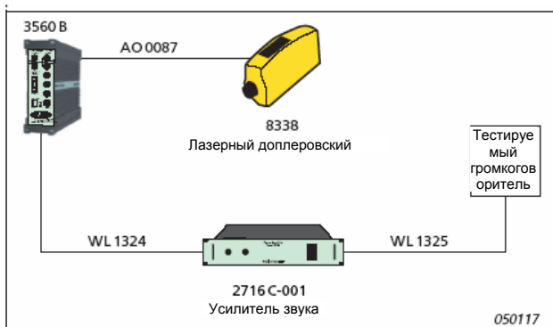
Рис. 12 Тестирование громкоговорителя с помощью лазерного доплеровского виброметра
