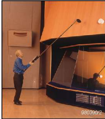
Рисунок 27. Отображение ослабления звука для поиска нарушений герметичности между студией и аппаратной
