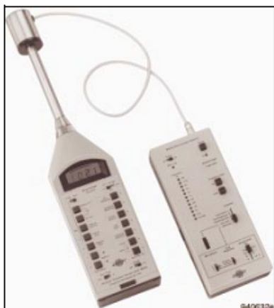
Рис. 3. Проверка и калибровка измерителя уровня звукового давления при помощи калибратора 4226.
