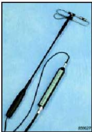
Рис.4 Блок дистанционного управления с подсоединенной рукояткой UA 1440
