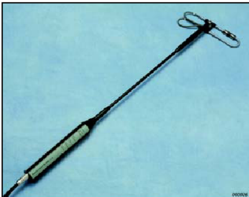
Рис. 3 Зонд для измерения интенсивности звука состоящий из: сдвоенного предусилителя (модель 2683) и микрофонной пары для измерения интенсивности звука (модель 4197). На рисунке зонд установлен на штангу-удлиннитель.
