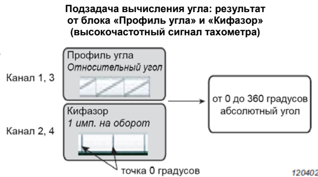
Рисунок 1. Блок «Профиль угла» (высокочастотный сигнал тахометра) и «Кифазор» (опорный сигнал тахометра), применяемые для выделения периода в приложении PULSE Reflex Angle Domain Analysis (Анализ данных в угловом базисе) типа 8740
