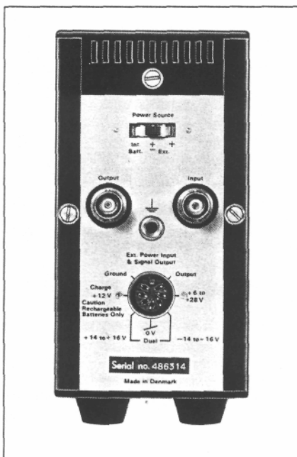
Рис. 2. Задняя панель усилителя-формователя сигнала 2635
