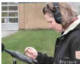
Рис. 11 Выполнение оценки тональности шума окружающего пространства
