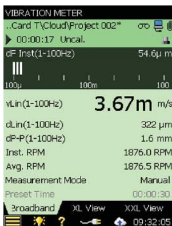
Рис. 2 Модуль расширенного анализа позволяет выполнять измерения скорости и перемещения
