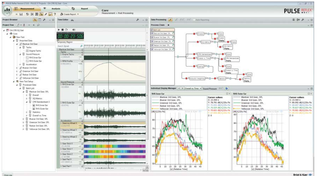
Рис. 3. Здесь показаны три основных компонента пакета PULSE Reflex Core: Time Editor (Редактор временных сигналов), Process Chain (Цепочка процесса) и Display Manager (Экранный менеджер). Пакетная обработка включена по умолчанию. Ее можно легко настроить с помощью графических элементов, представляющих данные и средства анализа
